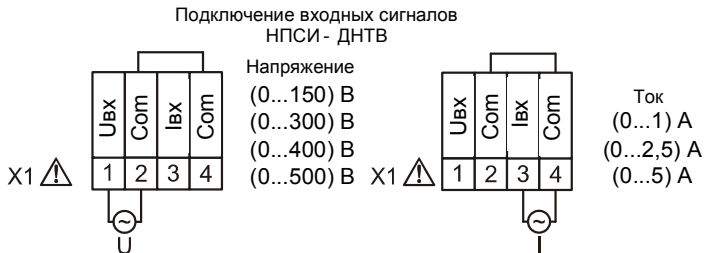
Рисунок 7а – Подключение входных сигналов к НПСИ-ДНТВ
